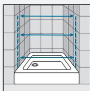
Prendre les mesures d'un mur à l'autre, en bas, en haut et au milieu et choisir la mesure inférieure. Relever les mesures après la pose du carrelage.
