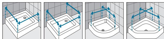
Prendre les mesures du mur au bord extérieur du receveur de douche. Relever les mesures après la pose du carrelage. Pour les montages en angle, il faut prévoir que la mesure réelle correspond à la mesure d'encombrement extérieur avec le profilé mural de la paroi en retour. Ceci doit être pris en compte impérativement pour les receveurs carrelés (pose à l'italienne ou receveur sans dalle).
