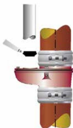
Pour réaliser une connexion en 32 mm ou 40 mm, retirer l'anneau intérieur du caoutchouc en utilisant la bague extérieure.
