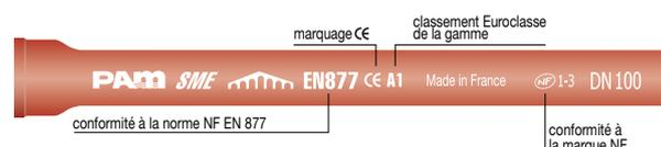
(\* ) DN = Diamètre Nominal = Diamètre intérieur
