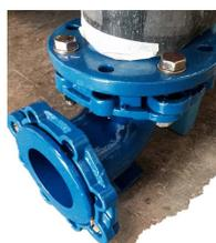
La bouche d'incendie a été conçue avec une bride orientable au niveau du coude à patin de façon à pouvoir ajuster au mieux l'orientation de la bouche par rapport à son environnement en surface et de faciliter le raccordement au réseau d'eau.
