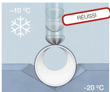
Essai de résistance aux chocs à froid, a reçu la distinction « flocon de neige »
