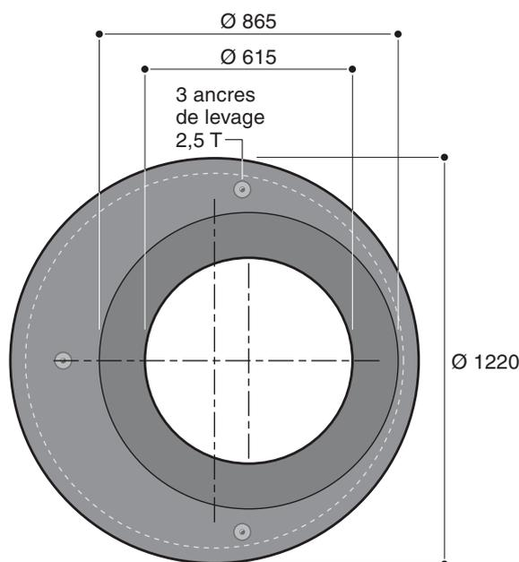
Dalles réductrices pour regards de visite Ø 1 000 avec emboîtement inférieur pour joint suspensif prélubrifié. Avec trou d'homme excentré.
