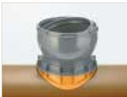
Raccord de piquage CONNEX DN/OD 160/162 sur un tuyau HSK, Perçage 162 mm \pm 1 mm
