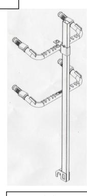
Positionner la crosse en mode d'utilisation Tapez légèrement sur la bague de maintien à l'aide d'un marteau Introduire le boulon de fixation
