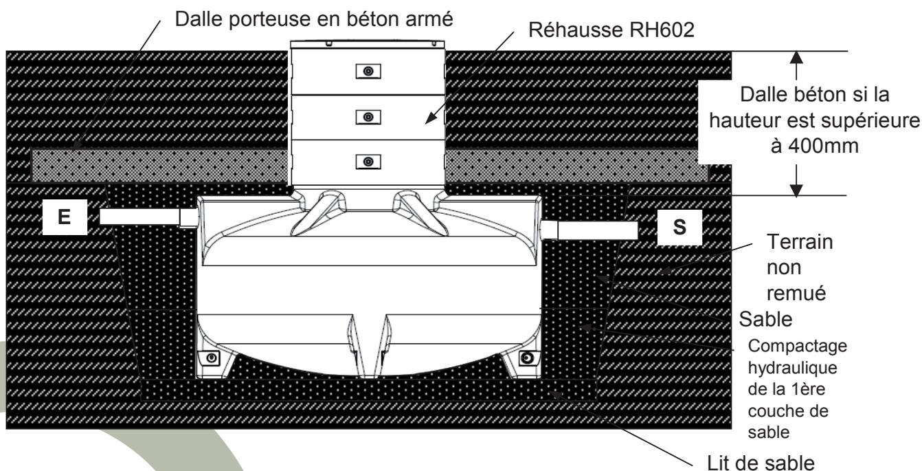
9) En cas de passage de véhicules, il y a lieu de couler une dalle porteuse en béton armé située au niveau de la réhausse juste au dessus de le génératrice de l'appareil. Cette dalle devra prendre appui sur le terrain non remué. Il sera nécessaire d'ajuster la hauteur avec une réhausse béton qui prendra appui sur la dalle porteuse en béton.
