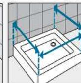
Prendre les mesures du mur au bord extérieur du receveur de douche. Relever les mesures après la pose du carrelage.
