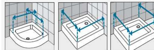
Prendre les mesures du mur au bord extérieur du receveur de douche. Relever les mesures après la pose du carrelage.
