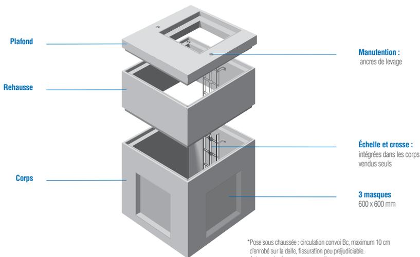
\*Pose sous chaussée : circulation convoi Bc, maximum 10 cm d'enrobé sur la dalle, fissuration peu préjudiciable. Autre cas de charge, nous consulter.
