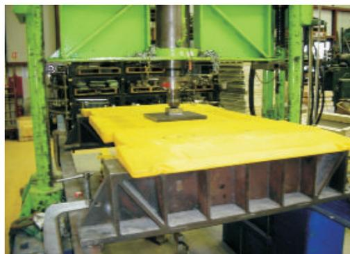
L'essai est arrêté dès que la plaque indique une flexion de 100 mm.
